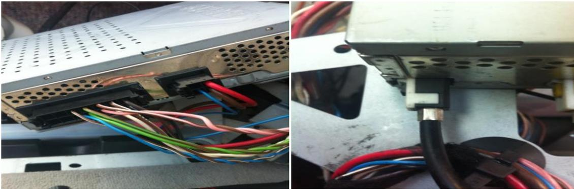
14 pol. Stecker für Lautsprecher, 4 pol. Stecker für Strom und Antennenstecker an der Elektronikeinheit (u.a. Verstärker) abziehen und mit den 2 Steckern des 17004 Kabelsatzes verbinden. Zusätzlich die Antennenleitung (Fakra Antennenstecker, wasserblau) verbinden.
