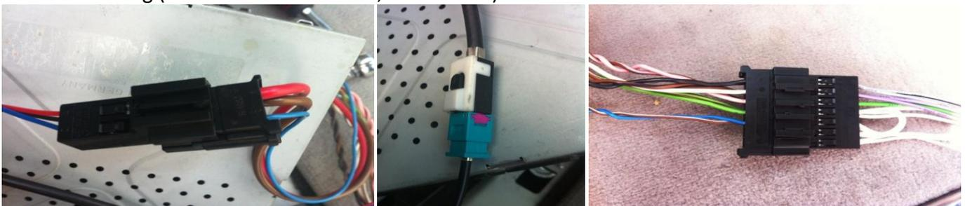
Die weißen losen Kabel werden benötigt, wenn auch die Subwoofer des Fahrzeuges (falls vorhanden) angeschlossen werden sollen. Hier ist ein zusätzlicher Verstärker notwendig. Dabei sind die einzelnen weißen Kabel mit dem Ausgängen eines Zusatzverstärkers wie folgt anzuschließen:
