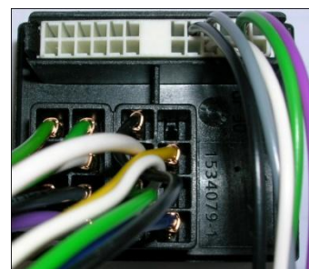
Quadlockstecker Kabelsatz nach Umbau
